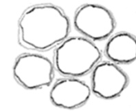
grani tondeggianti diametro uniforme
