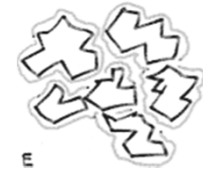
grani spigolosi + legante + resistenza - refrattarietà
