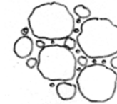
grani grossi e piccoli - porosità + resistenza
